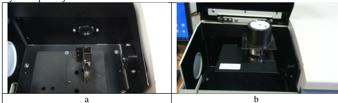
Rys. 6. Komora próbek w spektrofluorymetrze Hitachi F-7000 w konfiguracji pomiarów transmisyjnych w temperaturze pokojowej (a), oraz w temperaturze ciekłego azotu (b).
